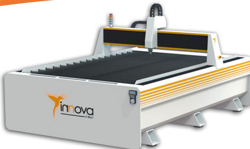
La gama de pantógrafos de corte por plasma Plasmacut Kompact son máquinas de diseño modular con estructura monocasco de puente móvil y mesa fija con sistema de aspiración selectorizado.
